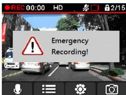
**Создание экстренных записей по сигналу G-сенсора:** если во время видеозаписи будет зафиксировано столкновение, DrivePro автоматически включит режим экстренной записи.
