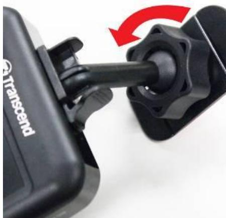
5. Quando la DrivePro è nella sua migliore posizione, ruotare la manopola in senso orario per assicurarsi che la DrivePro sia bloccata saldamente.
